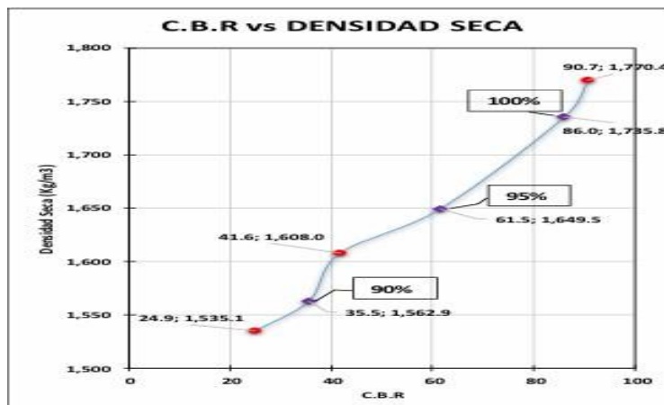
Figura 65. Suelo A - 1 – b, CBR vs DENSIDAD SECA
