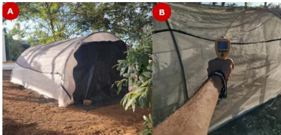
Figura 20. Montaje del invernadero experimental de DACA-UNI. 20A. Aislamiento estructural para minimizar el ingreso de contaminantes externos. 20B. Monitoreo de temperatura. Fuente: Elaboración propia .
