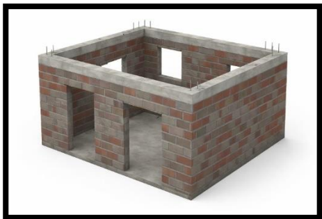
Figura 7. Vivienda cerrada en sus cuatro paredes, lista para recibir la estructura metálica de cubierta.
