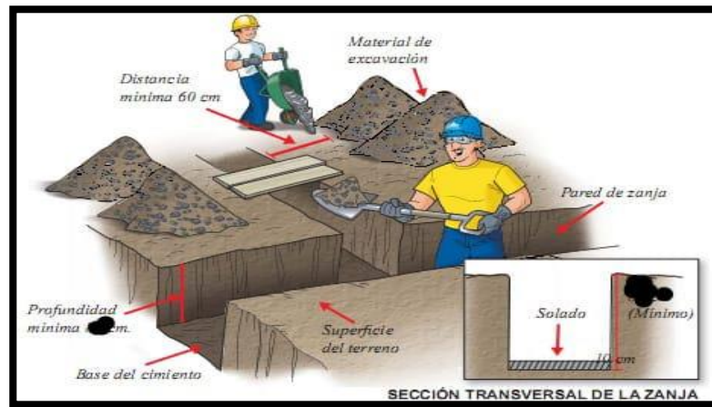
Figura 32. Sección transversal de la zanja
