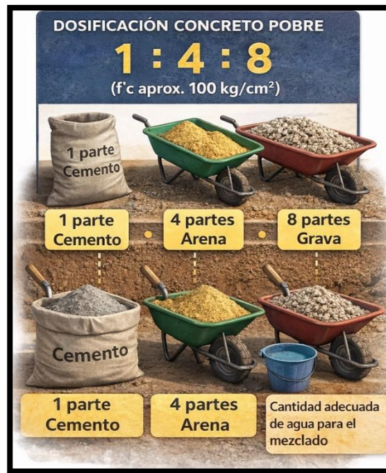
Figura 36. Dosificación del concreto pobre para la plantilla.
