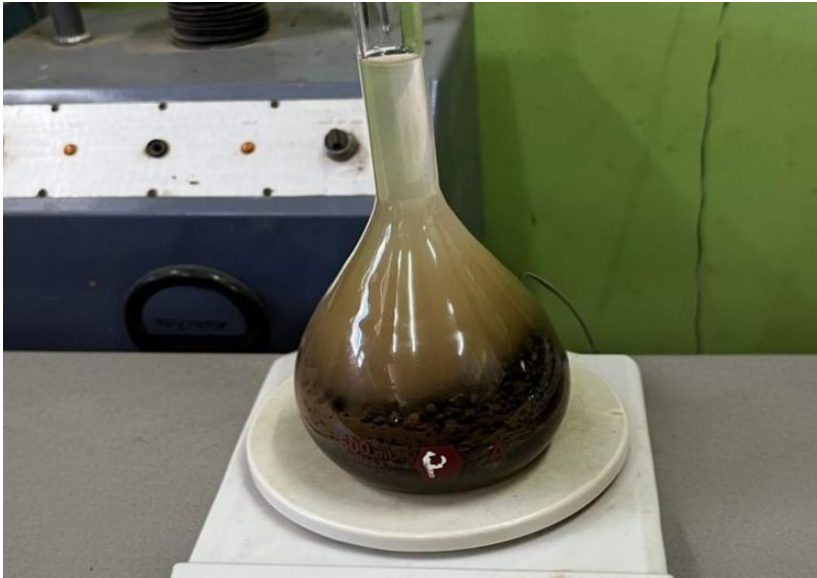
Imagen 2. Determinación de la gravedad específica y el porcentaje de absorción del agregado fino
