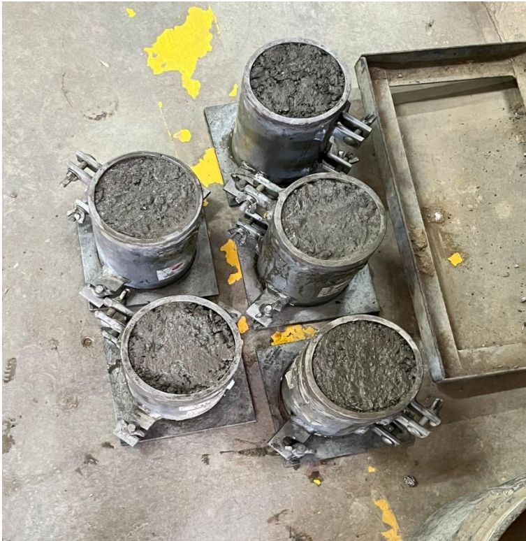
Imagen 17. Cilindros de concretos fabricados
