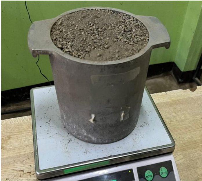
Imagen 3. Determinación del PVSS Y PVSC en laboratorio
