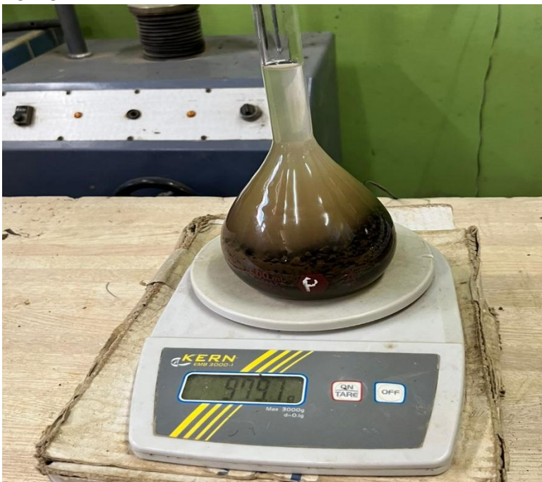
Imagen 14. Método del picnómetro para determinar la gravedad específica del agregado fino
