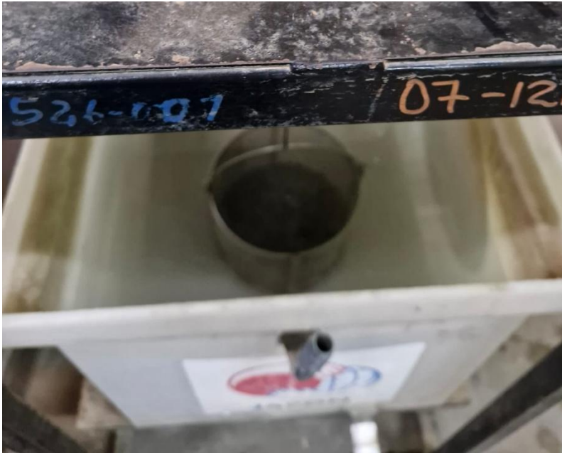
Imagen 13. Método de la balanza hidrostática para determinar la gravedad específica del agregado grueso
