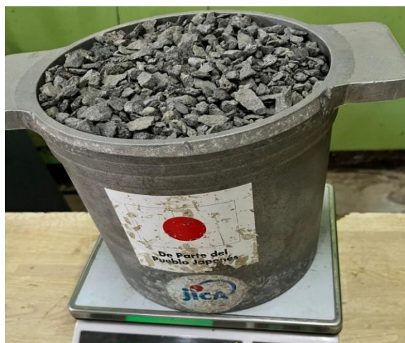
Imagen 5. Determinación del PVSS Y PVSC del agregado grueso mediante ASTM C29
