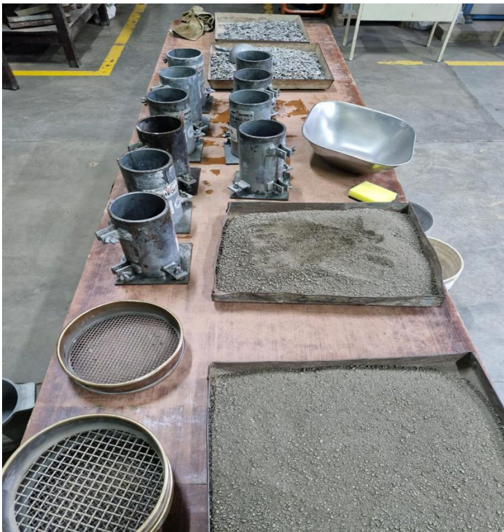
Imagen 10. Preparación de agregados para fabricación de concreto
