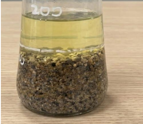
Imagen 4. Ensayo de impurezas orgánicas en el agregado fino
