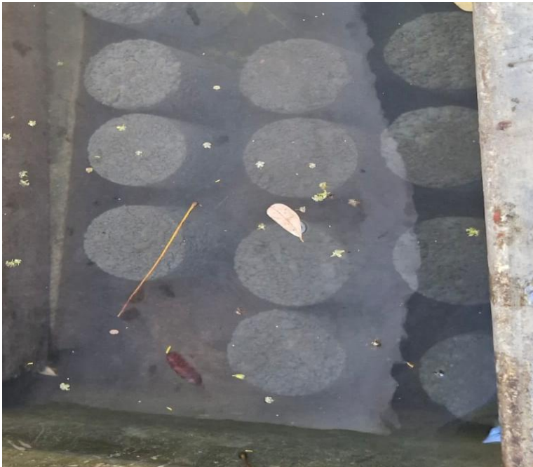
Imagen 18. Curado de cilindros de concreto
