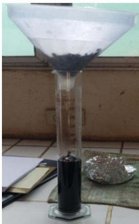
Ilustración 13: Carbón activado en proceso de lavado y filtrado.
