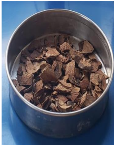
Ilustración 8: Endocarpio de coco, residuo industrial, limpio y listo para ser procesado como carbón.
