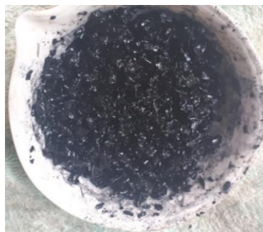
Ilustración 12: Carbón activado con una evaporación casi total del ácido fosfórico.
