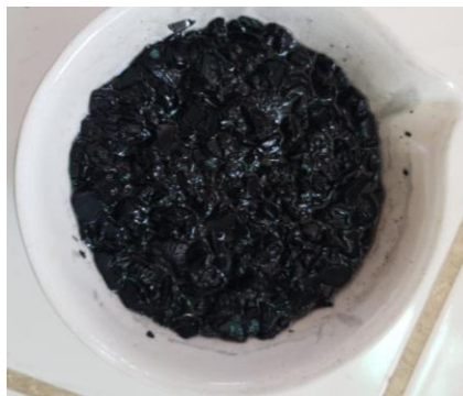
Ilustración 11: Carbón en proceso de activación por método de maceración.
