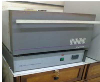
Ilustración 9: Mufla en laboratorio de procesos industriales.
