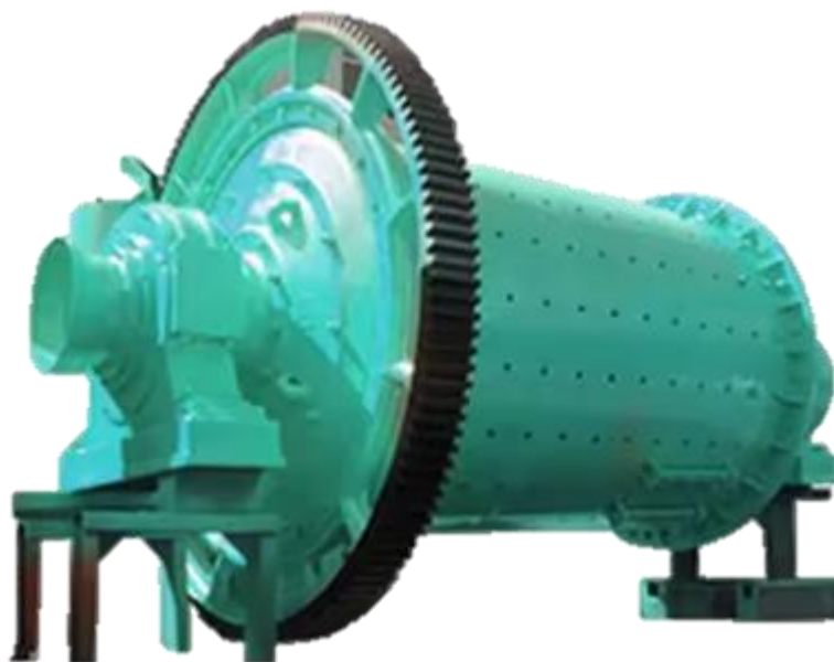
Ilustración 7: Molino de bolas acorde ficha técnica
