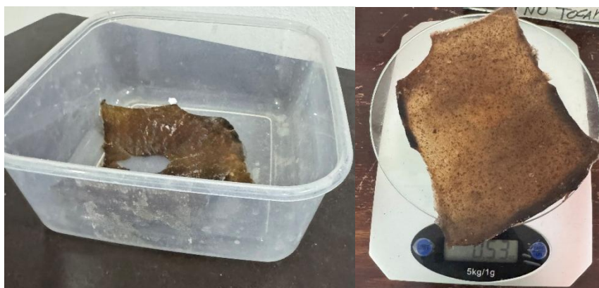
Figura 13. Evaluación de la biodegradabilidad en medio aéreo durante el periodo de 30 días de observación. (Fuente: Elaboración propia).
