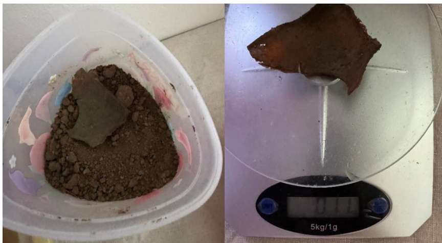
Figura 11. Evaluación de la biodegradabilidad en medio terrestre a los 30 días de observación. (Fuente: Elaboración propia).
