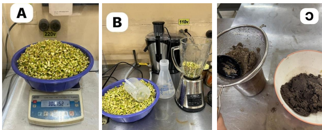
Figura 5. Proceso de extracción del almidón. A) Pesado de las cáscaras de plátano. B) Trituración de la materia prima para separar lo gránulos de almidón. C) Colado de la mezcla triturada. (Fuente: Elaboración propia).
