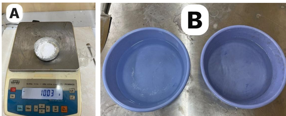
Figura 3. Preparación de solución anti-pardeamiento. A) Pesaje de metabisulfito de sodio. B) solución con agua destilada y metabisulfito de sodio al 1%. (Fuente: Elaboración propia).
