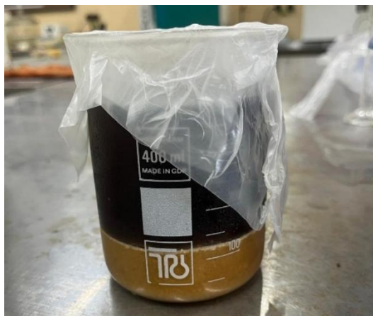
Figura 6. Sedimentación del almidón al transcurrir 12 horas. (Fuente: Elaboración propia).
