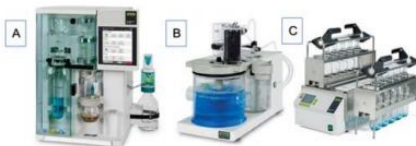
Figura 7. Equipo Kjeldahl: A. Destilador; B. Scrubber; C. Digestor. (Fuente: Elaboración propia).
