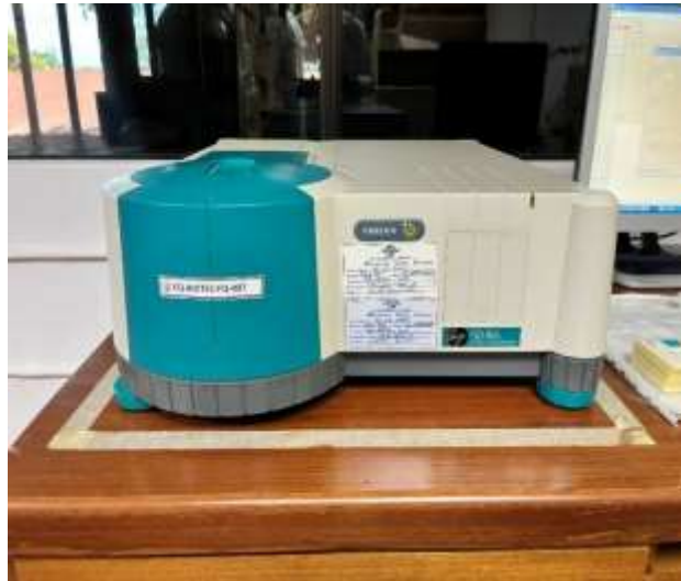
Figura A 16 Espectrofotómetro Varian usado para contabilizar los carotenos
