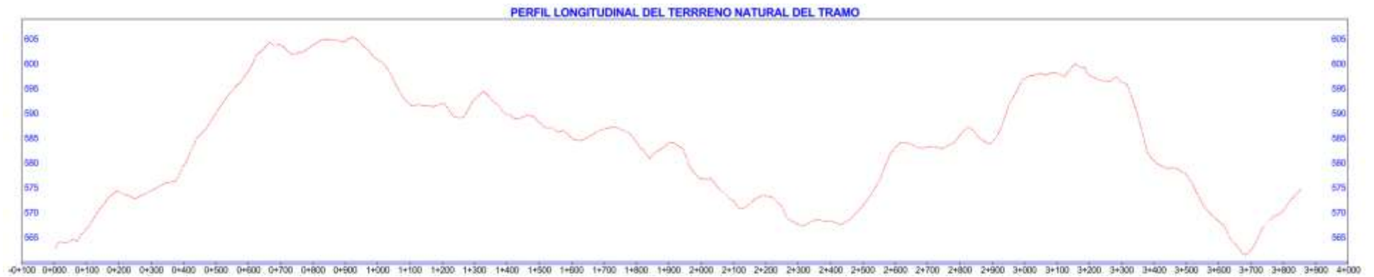
Figura 20. Perfil Longitudinal del Terreno Natural del Tramo
