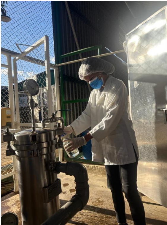
Figura 22. Toma de muestras en salida de PM2(Salida del sistema de coagulación-Floculación)
