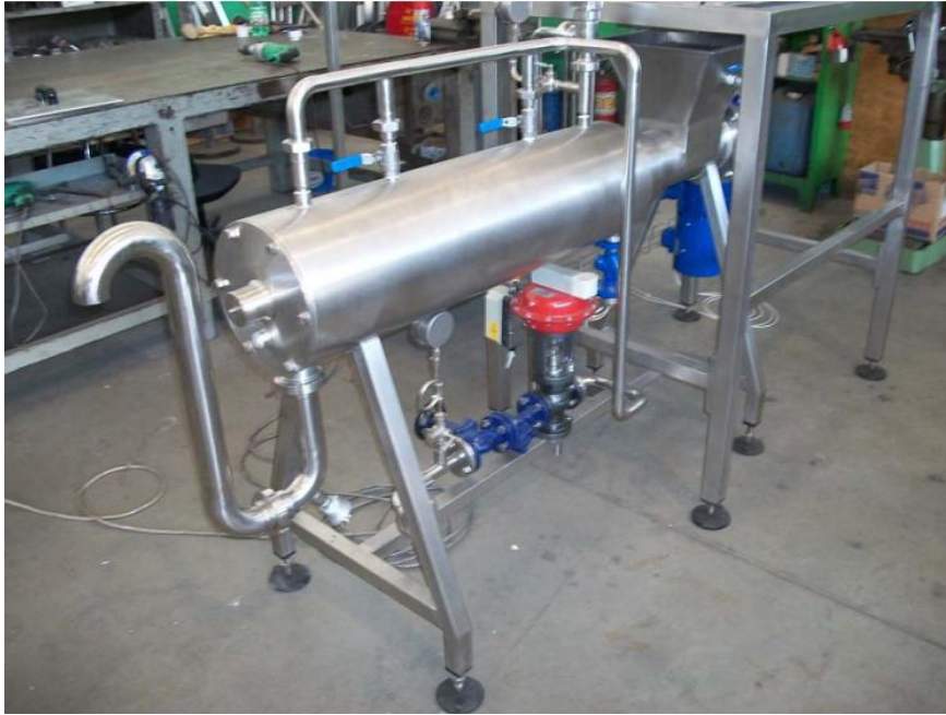
Figura 14: Cocinador cilíndrico continuo con sistema Cold Break
