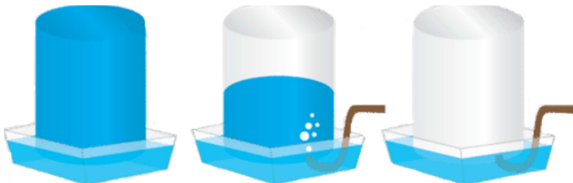
Figura 12. Recogida de gas por desplazamiento de agua
