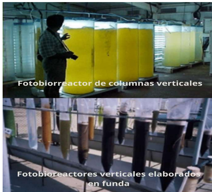
Figura 8. Fotobiorreactor de columnas verticales y Fotobiorreactores verticales elaborados en funda
