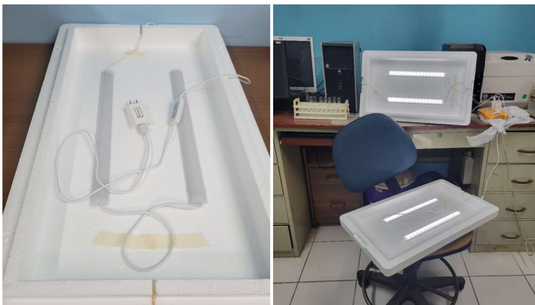
Figura 20 . Disposición de las luces en la tapa de la hielera
