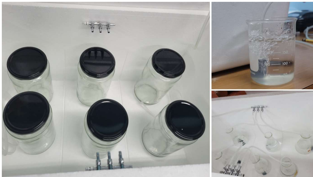
Figura 22 . Distribución de bioreactores y ajuste de flujo volumétrico
