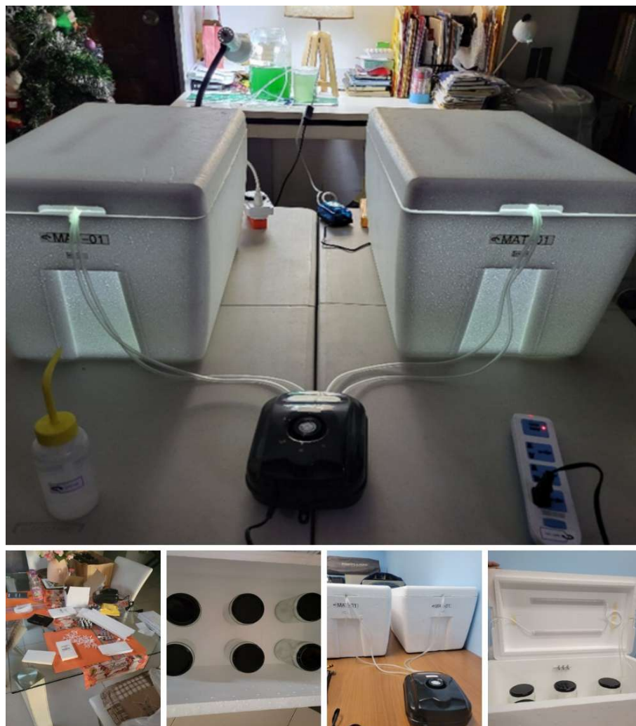
Figura 23 . Elementos y montaje del sistema y bioreactores
