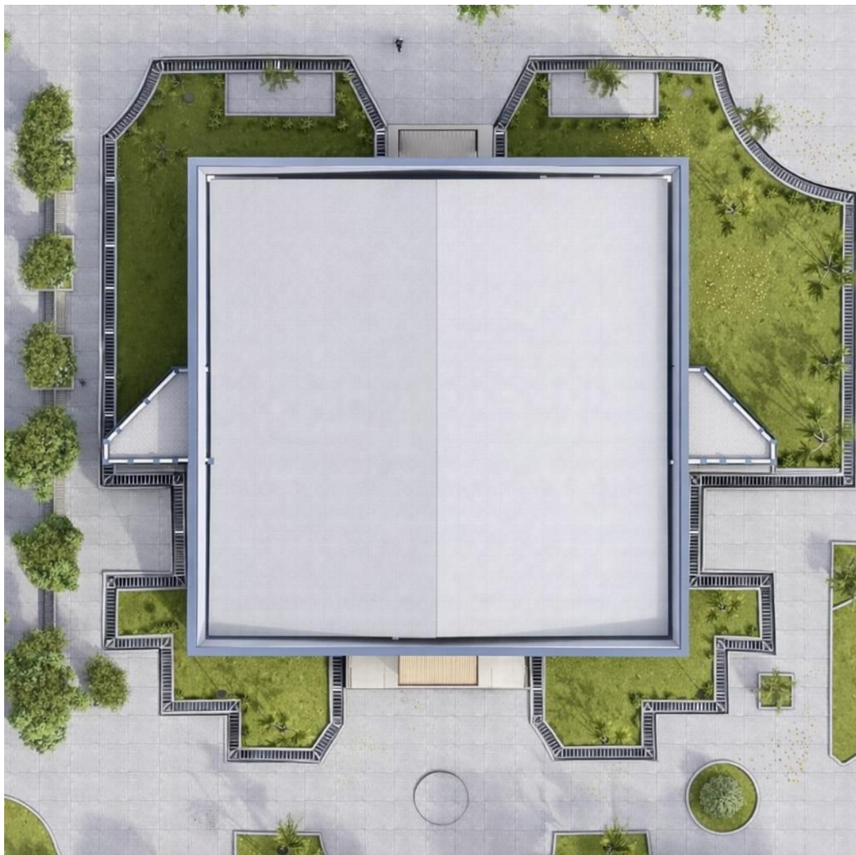
Figura 38 Vista en planta de techo con sistema termopanel y rejillas de drenaje pluvial. Elaboración propia.
