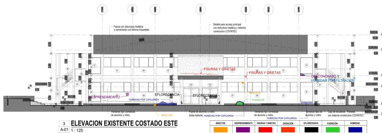
Figura 9 Elevación Este, Biblioteca Esman Marín, identificación de las patologías encontradas. Fuente: "Propuesta de Mejoramiento de Climatización del Edificio de la Biblioteca Esman Marín (UNI-RUSB, elaborada por Br. Eddy Trejos y Br. Orlando Gutiérrez en julio de 2017)" - Elaboración Propia.
