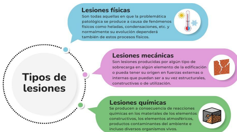
Figura 3 Clasificación de lesiones según proceso patológico en edificios. Fuente: Autores.
