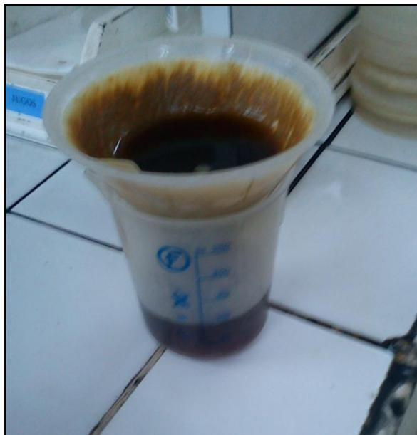
**Figura 7.3:** Filtrado de Nutsch frío
