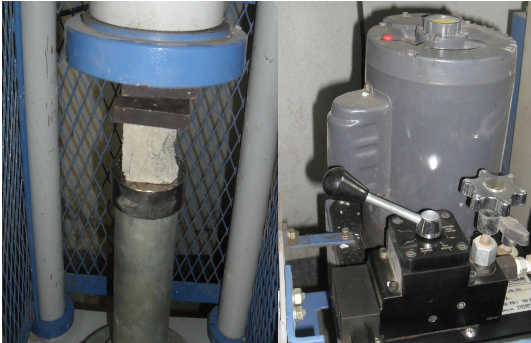
Figura 7. Maquina hidráulica para ensayo de RMC
