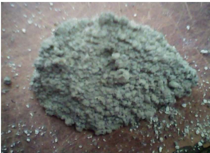
Figura iv. Espécimen destruido después de ensayo RMC (Poca resistencia)
