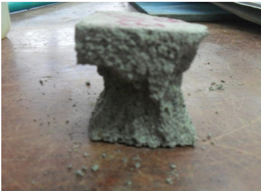
Figura iii. Espécimen después de ensayado la RMC (buena resistencia)
