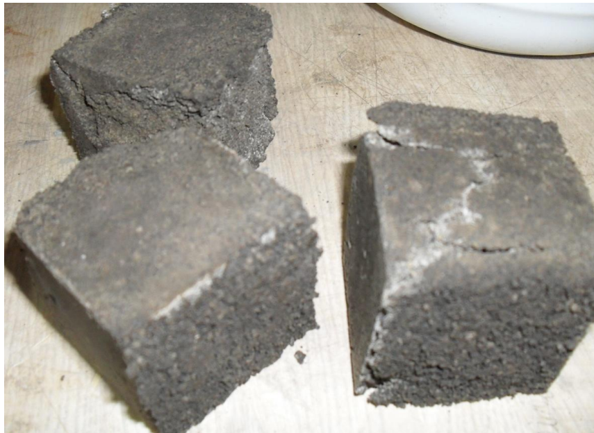
Figura viii. Geo-polímeros al 12% de \text{Na}_2\text{O} después de ensayo RMC
