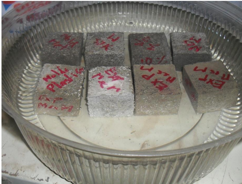
Figura 8. Especímenes en solución de \text{MgSO}_4 al 5%
