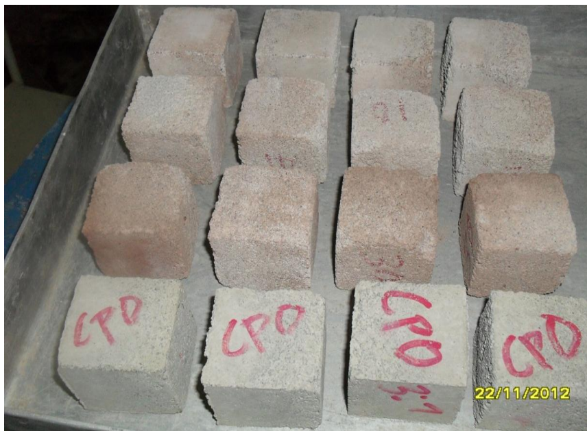
Figura vi. Especímenes selectos después del ataque por altas temperaturas junto a especímenes de referencia.
