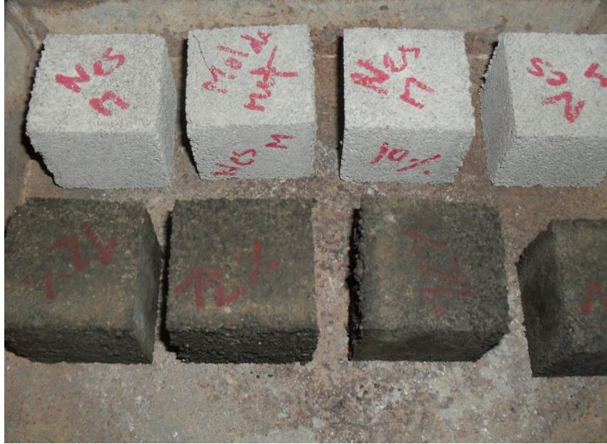
Figura vii. Especímenes compósitos (más claros) y geo-polímeros al 12% de \text{Na}_2\text{O} (más oscuros)
