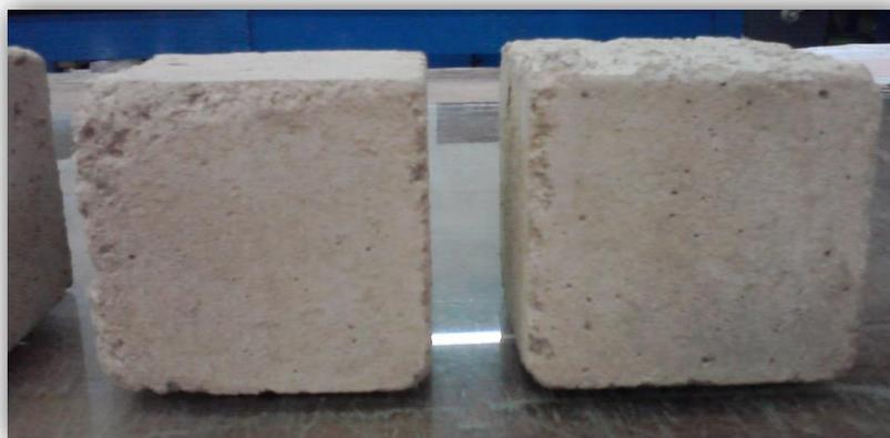
Figura 20. Aspecto físico de los morteros después del tratamiento térmico a 900°C
