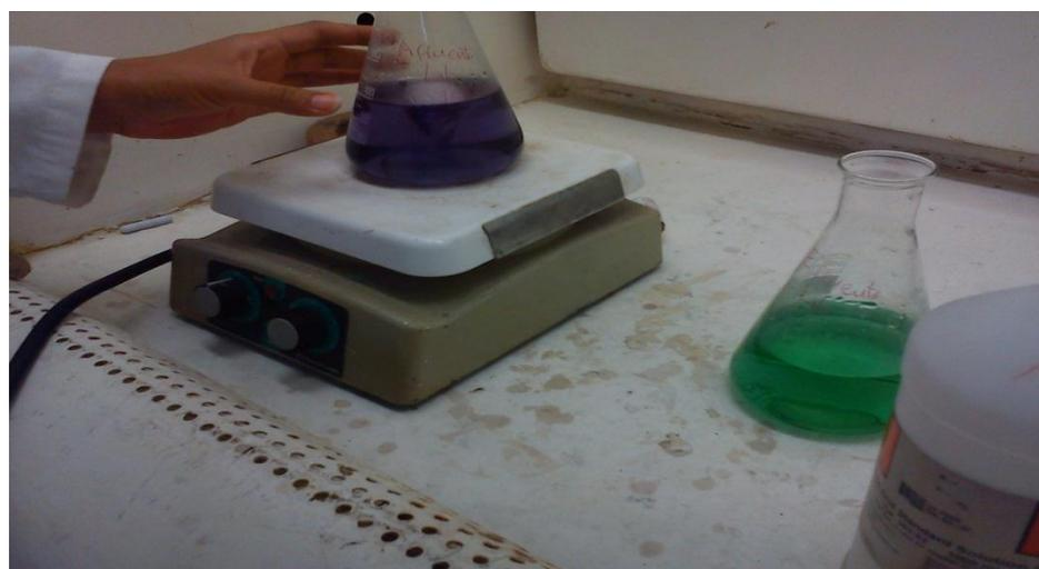
Figura E.7 Titulación para pruebas de laboratorio
