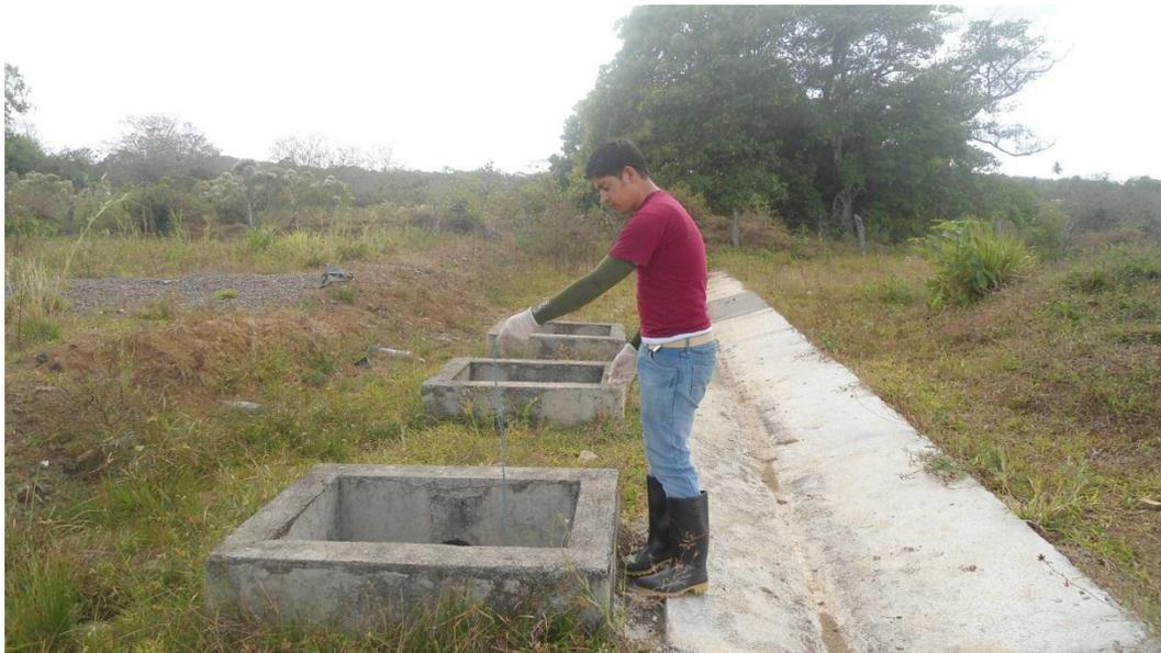
Figura E.1 Toma de muestras de efluente
