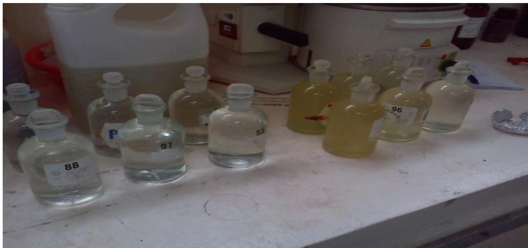
Figura E.3 Winkler para DBO
