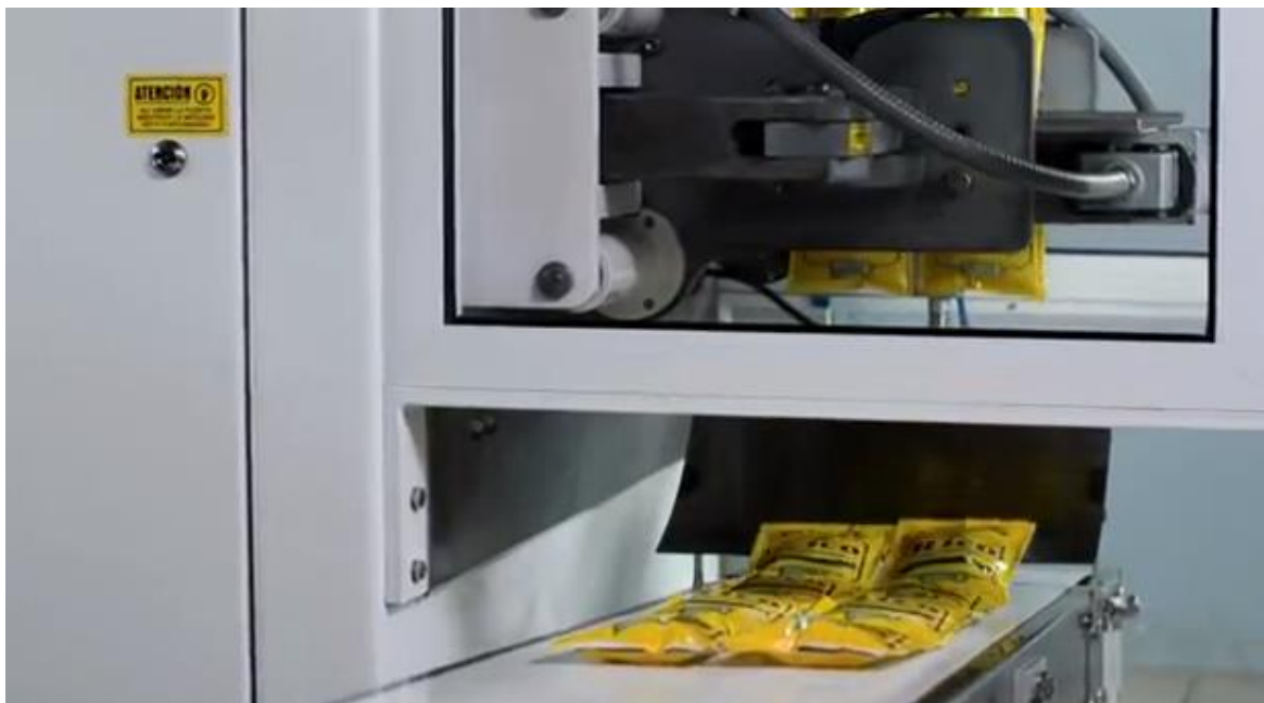
Figura 6.18. Llenado, corte y transporte de bolsas de 185 ml de aceite “Rico” en la Máquina HPM.
