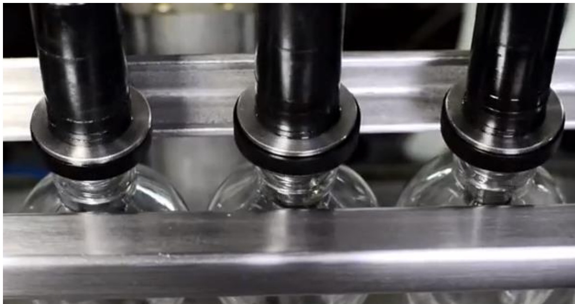
Figura 6.6. Proceso de envase de aceite “Rico”, en botellas de 1 Litro, en la Máquina ACASI
