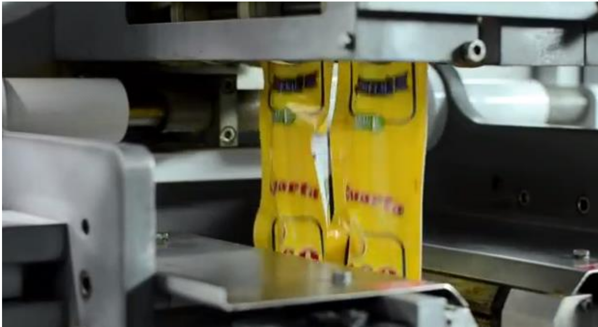
Figura 6.17. Llenado de aceite “Rico” y corte simultaneo de bolsas de 185 ml en la Maquina HPM
