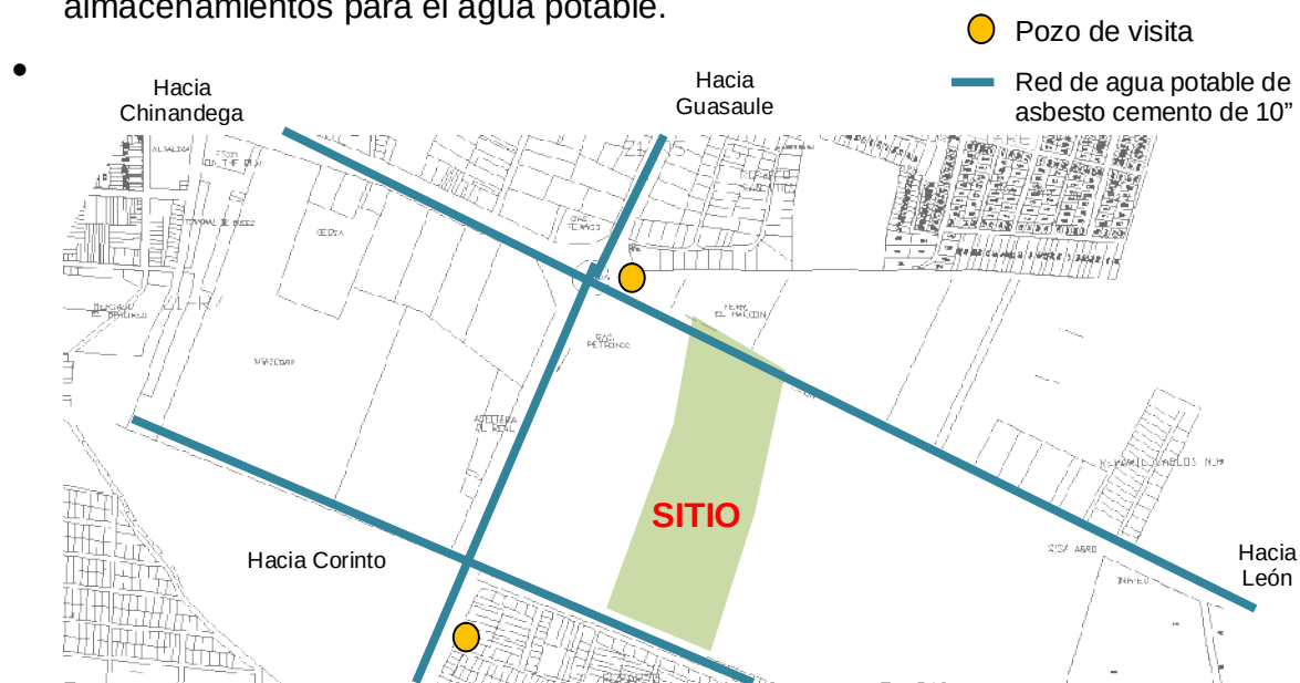
Grafico 15 Sistema de distribución de agua potable Fuente: ENACAL Ing. Luigi José Navas tercero
