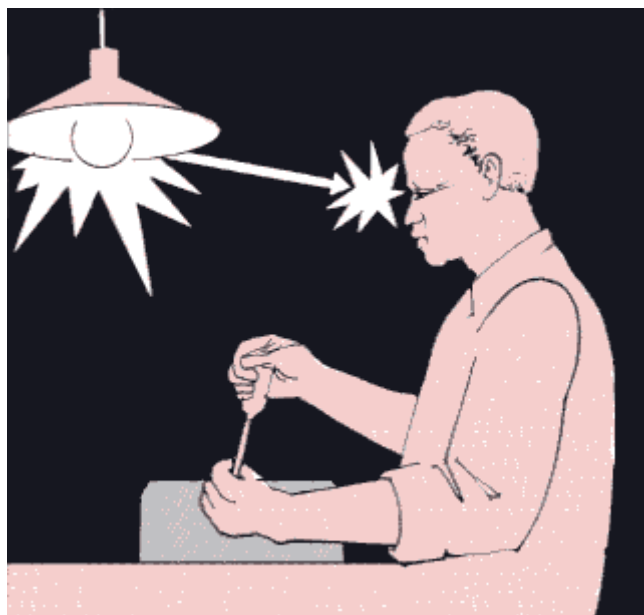
Figura No 3. Encandilamiento debido a una lámpara de techo baja, colocada incorrectamente.
