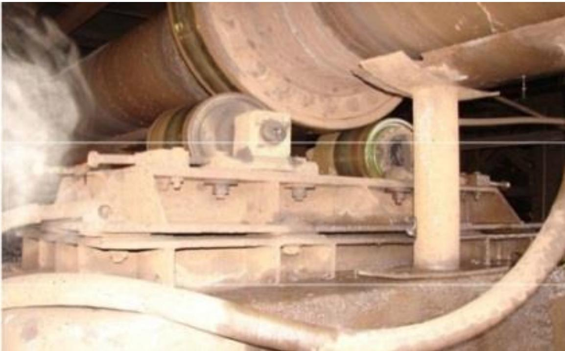
Figura 1: Rodillos del transportador yacobi en explotación junto a la yanta.
