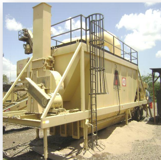
Foto No.18 Cámara de filtros
