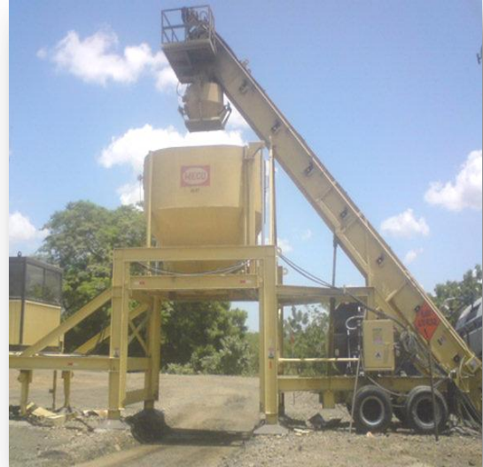
Foto No.22 Silo y Drag conveyor
