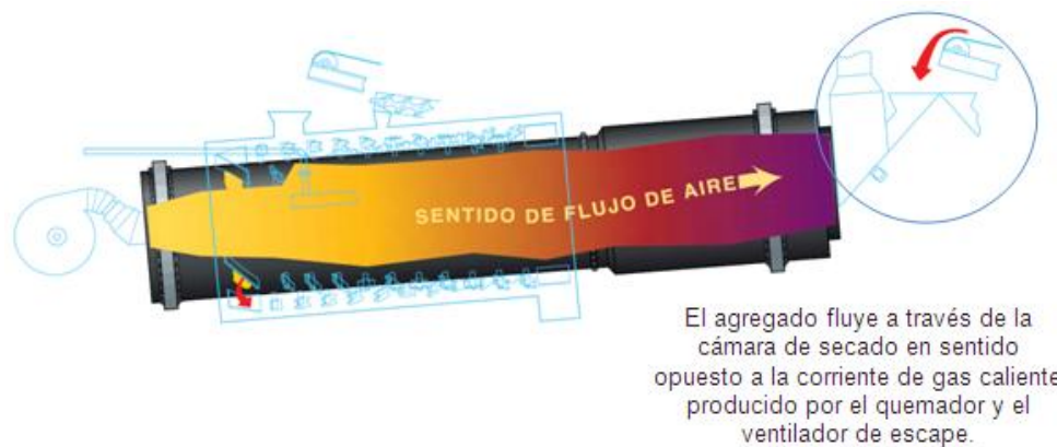
Figura No.22 Entrada del agregado al tambor.
