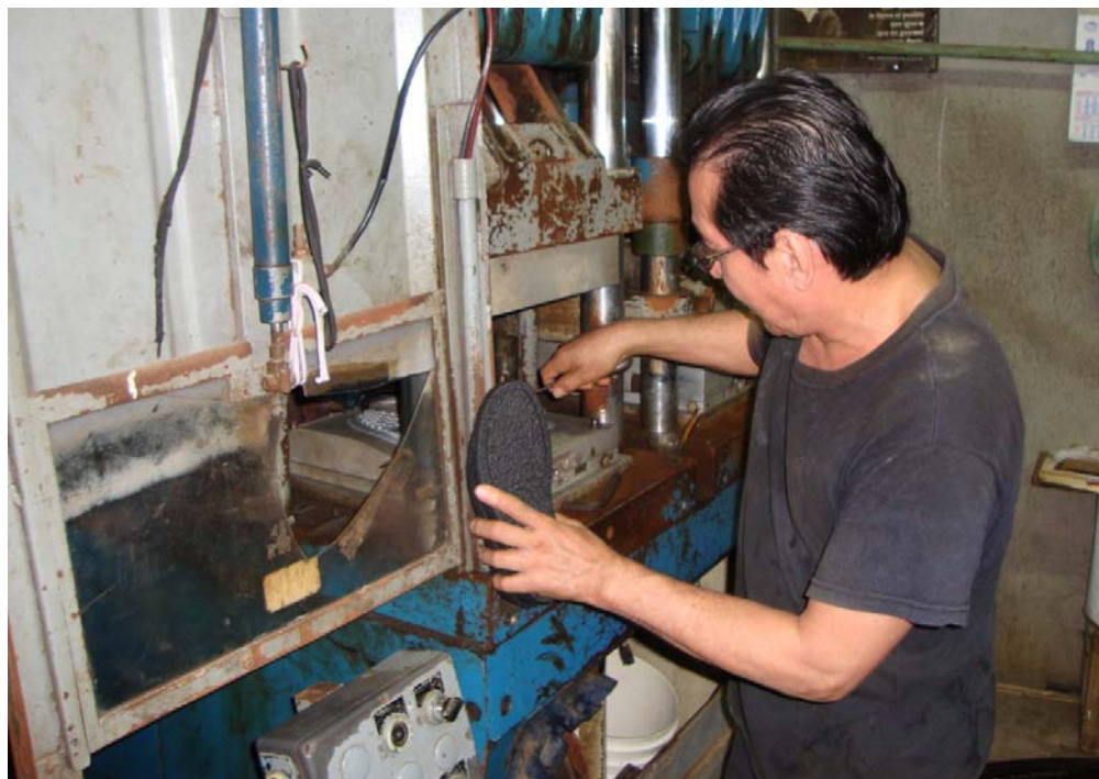
Anexo 13: Inyectado de suelas.
