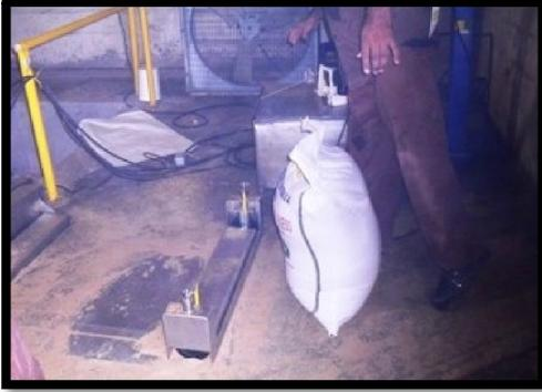
La Harina de Carne y Hueso es empacada en sacos de polipropileno, con capacidad de 100 lbs. En esta etapa el operario no hace contacto directo con el producto, ya que el transportador que viene del molino está provisto de un embudo, en el cual se coloca el saco y se rellena.
