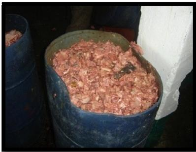
Una vez triturado el hueso, se transporta a través de un colcho helicoidal hasta un refinador, a fin de disminuir aun más el tamaño del hueso, esto con el propósito de que el tratamiento térmico sea uniforme. Garantizando así, un esterilizado durante el proceso de cocción y se evita forzar los equipos.
