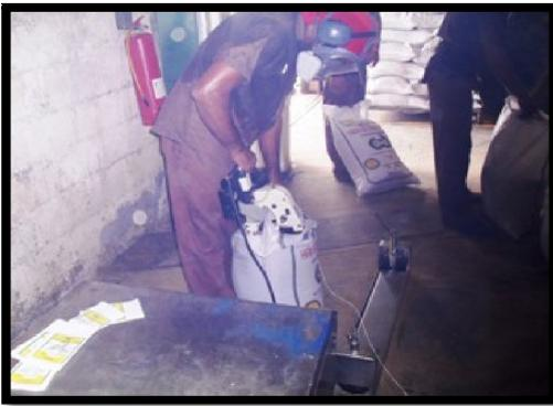
La Harina empacada, se pesa en una báscula electrónica hasta obtener un peso de 100 lbs. Una vez obtenido el peso deseado, el saco es sellado con una máquina de coser industrial. En esta etapa se etiqueta el producto, a fin de indicar las especificaciones técnicas del producto.
