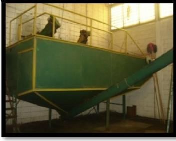
En esta etapa el material prensado, se deposita en un silo de almacenamiento temporal, el cual está provisto de un ventilador industrial, que ayuda a disminuir la temperatura del producto, evitando así la degradación de las proteínas. Este proceso tiene una duración aproximada de 12 horas.
