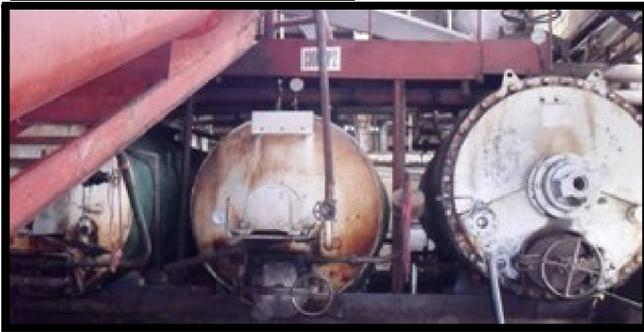
El material tanto duro como suave es transportado por medio de un colcho helicoidal para alimentar a los cocedores, esta operación se realiza en un equipo cilíndrico que lleva una puerta de descarga inferior en la parte delantera. El conjunto
