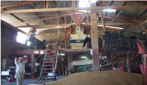
El trillado consiste en remover del grano la cáscara, el pericarpio y el embrión con un máximo de pulimento y mínima ruptura del grano, realizado en los diferentes procesos operacionales fundamentales tales como limpieza,
