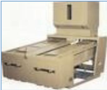
Esta función operativa tiene por objeto la separación de los granos descascarado de los no descascarado y el retorno de estos últimos a la Descascaradora para que reciban de nuevo la acción y lograr mejores rendimientos en el descascarado. Esto se logra haciendo pasar el arroz por mesas con celdas interiores
