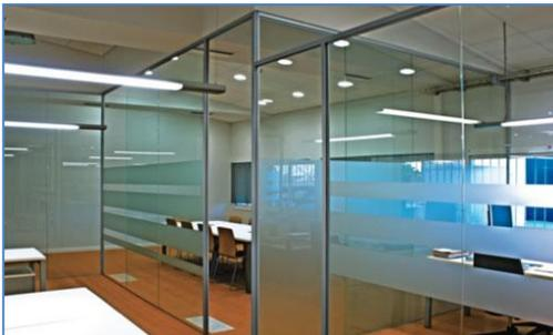
Este modelo está compuesto por una estructura de aluminio vista con acabados anodizados o lacados, con una canal para el alojamiento de un tablero de 16 mm. de espesor y el ajunquillamiento de goma base-cuña para cristales de 5 mm. Las puertas de las mamparas, fabricadas en madera melaminada son de 35 cms. de espesor y pueden ser combinadas con mirillas acristaladas acopladas en la mampara de oficina.
