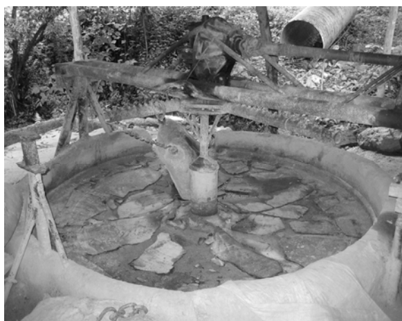
Fig. 1 Equipo para la molienda de minerales de oro en la Rastra de las Chicotas ubicada en las afueras de la Libertad, Chontales.
