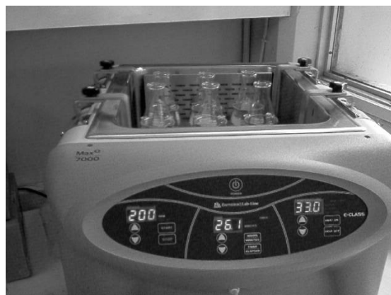
Fig. 3 Agitador rotatorio utilizado para experimentos de adsorción de mercurio en quitosano.
