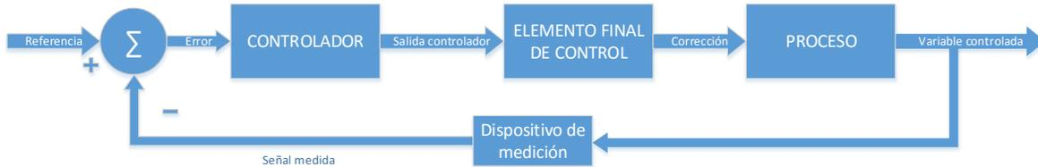
Figura 2. Diagrama de bloques sistema de control de lazo cerrado
