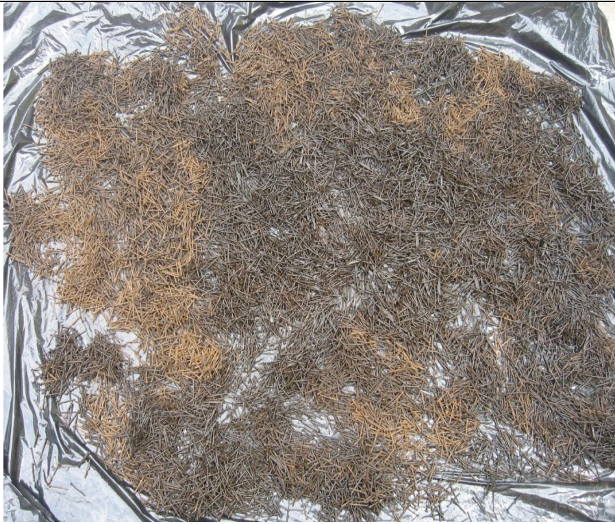
Foto 3. Clavos Oxidados utilizados en filtros KANCHAN y SONO filter.
