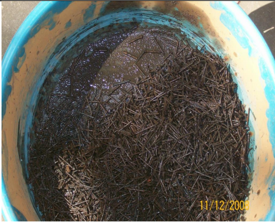
Foto 7. Lodo acumulado en fondo de pana del filtro KANCHA.
