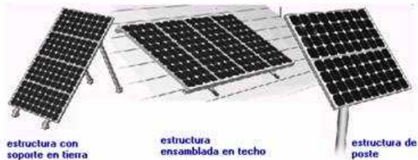
Figura 6: Tipos de estructuras.
