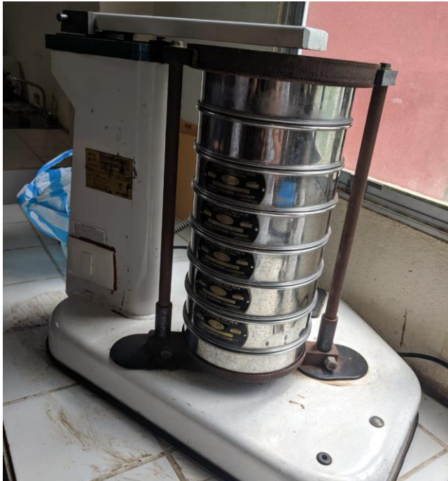
Figura 25. Realización de prueba de granulometría de la harina de frijoles.
