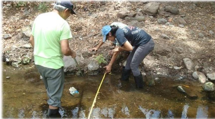
**Figura 12. Levantamiento de sección en el Río Fonseca**
