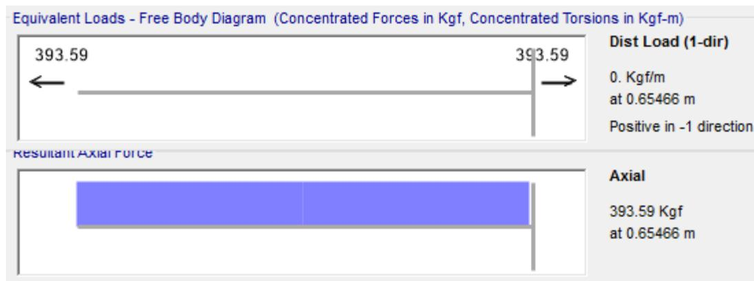
**Figura 5-7.** Mayor fuerza axial en elementos diagonales de la armadura
