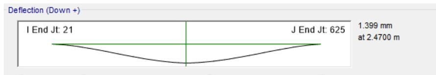
**Figura 5-24.** Deflexión por carga CV en viga transversal W 12 x 45. Fuente: ETABS.
