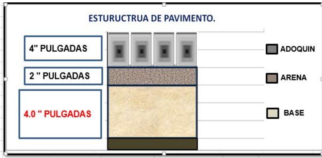
Imagen N°7: Estructura Final de Pavimento articulado.
