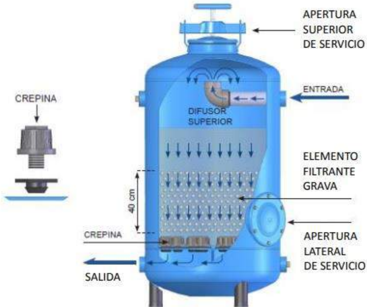
Ilustración 35 Partes del filtro
