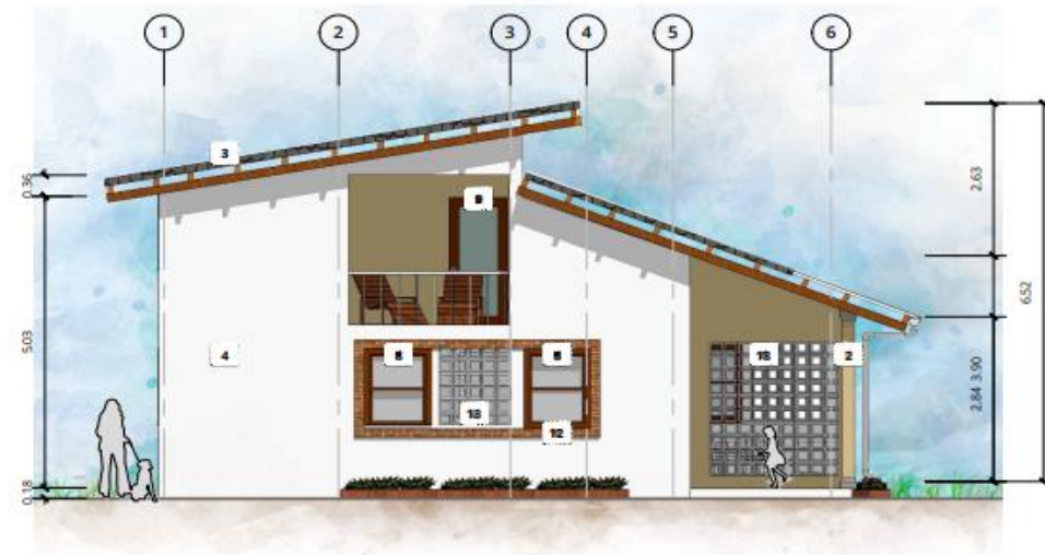
02 Elevación Lateral Derecho / Right Side Elevation 1:75
