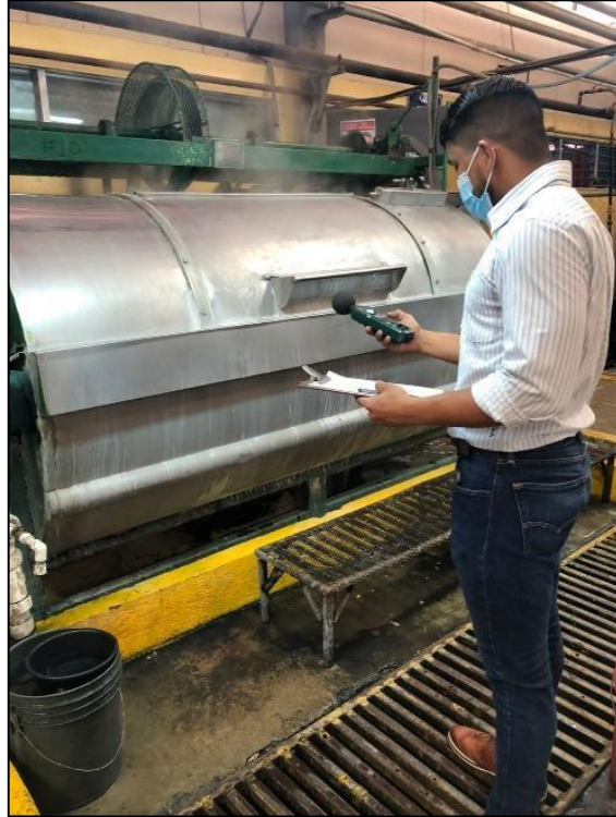
A-6. Medición de higiene industrial en el área de lavandería.
