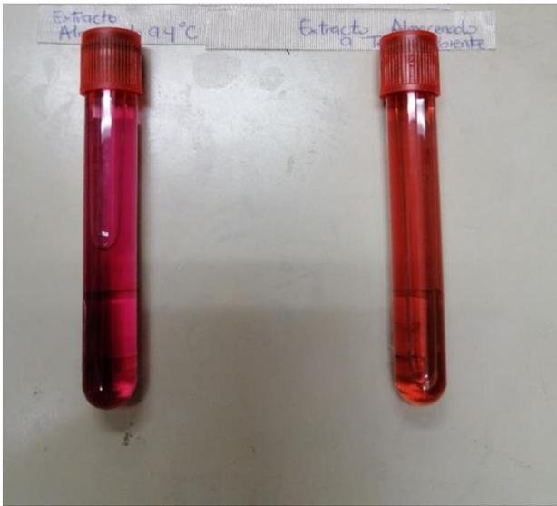
**Figura C-19.** Extractos colorantes almacenados a 4 °C y a 30°C, 7 días después de la extracción
