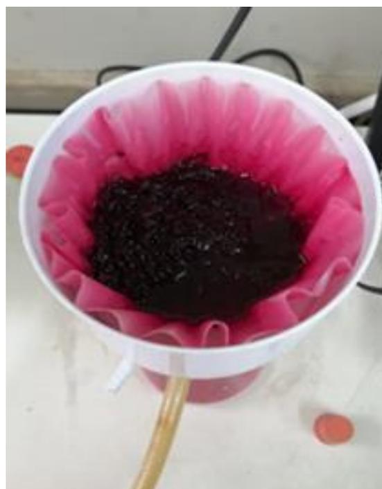
**Figura C-10.** Sólido inerte separado del extracto
