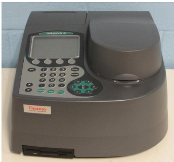
**Figura B-3.** Espectrofotómetro UV- visible, Genesys 6
