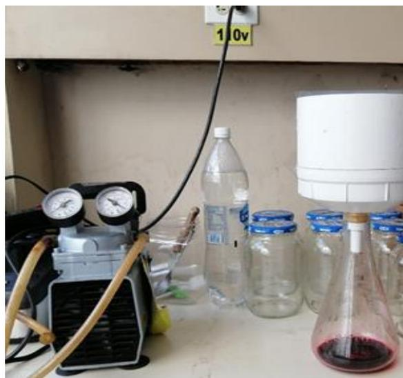
**Figura B-2.** Bomba al vacío – embudo Buchner
