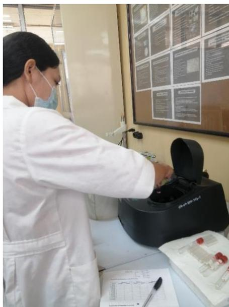
**Figura C-17.** Lecturas de absorbancias en el espectrofotómetro
