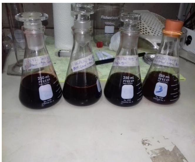
**Figura C-13.** Extractos sometidos a calentamiento con temperatura constante de 78° por 90 minutos
