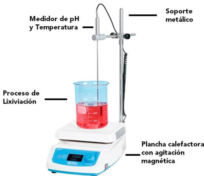
**Figura 5.1** Esquema del arreglo experimental con plancha de calentamiento con agitación para la lixiviación
