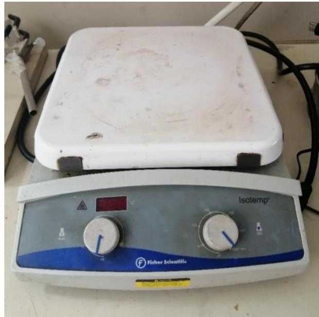
**Figura B-1.** Plancha de calentamiento con agitación termica
