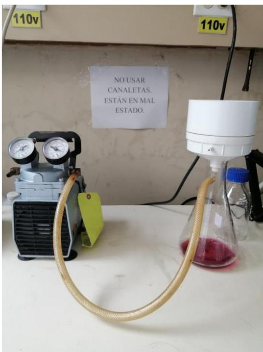
**Figura C-9.** Filtración a vacío del extracto acuoso colorante
