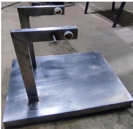
El brazo de la figura 61, se fabricó a partir un tubo rectangular  $\frac{3}{4}$ " x  $1\frac{1}{2}$ " de acero 304L ASTM A554 cortado a una longitud de 365 mm, a 65 mm de uno de sus bordes se perforó un agujero de 20 mm por donde pasa el eje, con centro en el agujero en la parte inferior se taladró un agujero de  $\frac{1}{4}$ " y se soldó una tuerca de  $\frac{1}{4}$ " de acero inoxidable en la que se enrosca un perno como prisionero.
