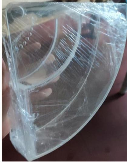
Todas las piezas, se unieron mediante un pegamento para acrílico, lijando primeramente los puntos de contacto para una mejor adherencia con el pegamento, luego de un tiempo de secado en la junta se aplicó un sellado con silicón blanco para la eliminación de filtraciones de agua, para finalizar se ensambló todo para la realización de pruebas. Figura 68.
