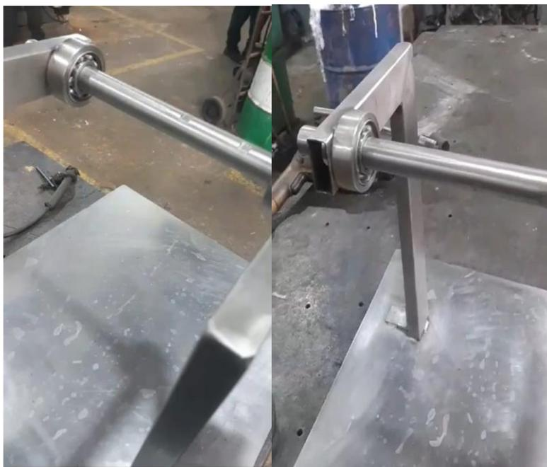
Para la elaboración de la base, se utilizó un angular de 2" x 2" de acero inoxidable cortando dos piezas de 500 mm de longitud y 400 mm, ambos cortes se realizaron a 45° para el armado del marco, sobre este descansa una lámina de acero inoxidable de 400 mm x 500 mm, sobre la que se soldaron las escuadras que soportaran el sistema.
