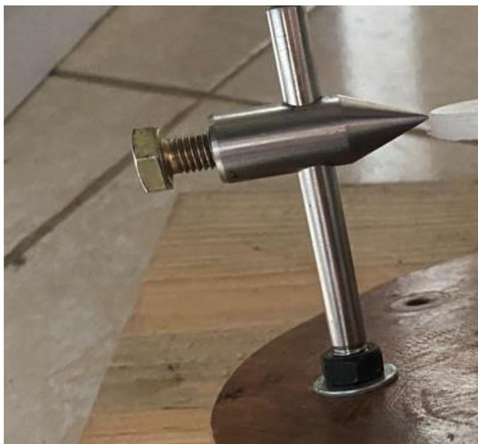
Una vez cortadas las varillas roscadas en la longitud correcta y montado el medidor de nivel se ensambló todo el conjunto quedando solamente por añadir el eje que sujeta el deflector y el plato porta pesas.
