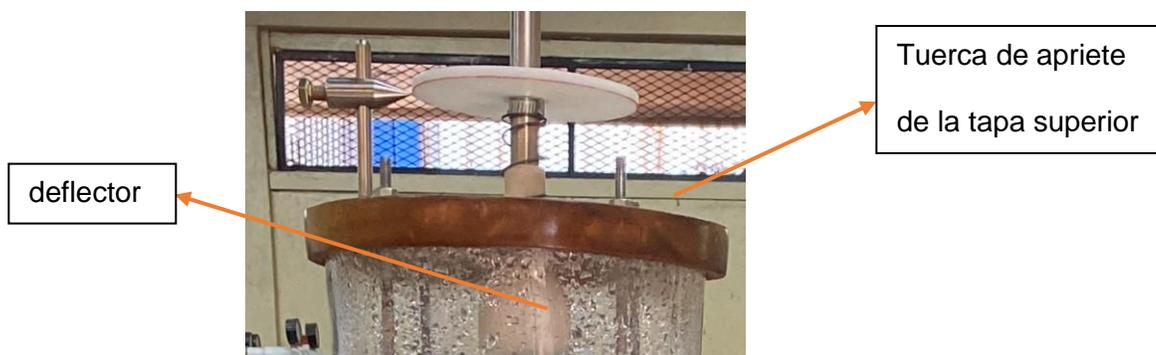
2. Ajustar la altura del puntero (medidor de nivel) mediante el tornillo prisionero (este apriete se realiza a mano) con el porta pesas, asegurándose de que se ha hecho bien, haciendo fluctuar el soporte verticalmente, y observando que se sigue manteniendo en la posición en la que se había colocado inicialmente el medidor de nivel.
