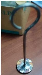
Los pesos se obtuvieron de una platina inoxidable 1" de espesor mediante una esmeriladora de 4 ½" se lograron cortar cuatro piezas de dimensiones 52 mm x 52 mm, estas mediante un torno paralelo se refrentaron ambas caras y se cilindraron cada una a las dimensiones proporcionada en los planos.
