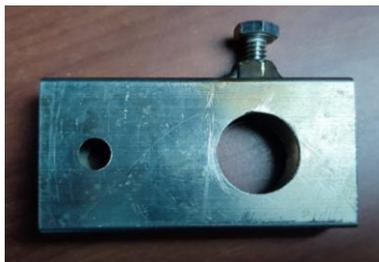
Para la colocación de los pesos (porta pesas) se cortaron cuatro platinas inoxidables de 40 mm de longitud las cuales encamisan al tubo rectangular que se utiliza como brazo, posterior al corte, se soldaron las platinas con TIG. En la cara inferior de la platina en el centro se soldó un gancho para el peso, permitiendo que la carga se vuelva puntual. Figura 64.
