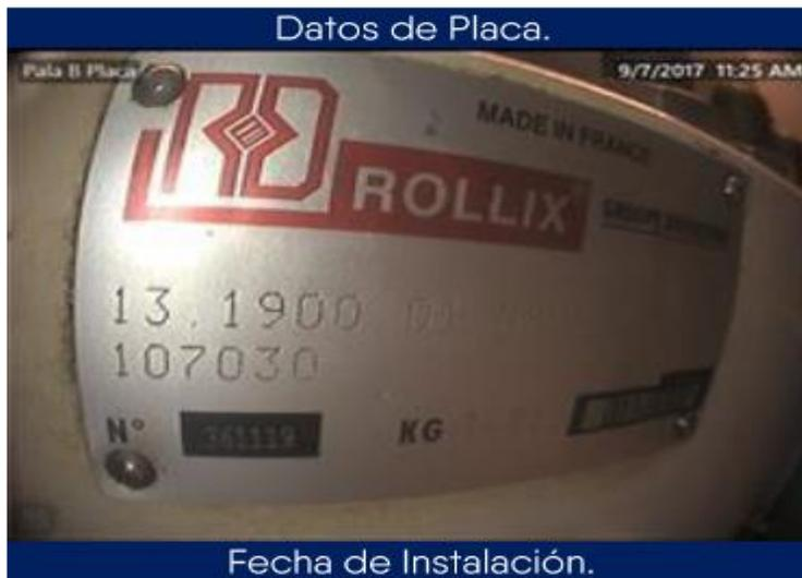
Fotografía de la placa de Rodamientos originales que traía instalados la turbina y fue comisionada en noviembre de 2012.
