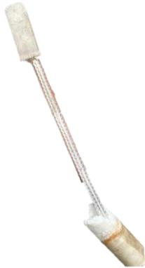
Figura D.4 Sensor de temperatura superficie
