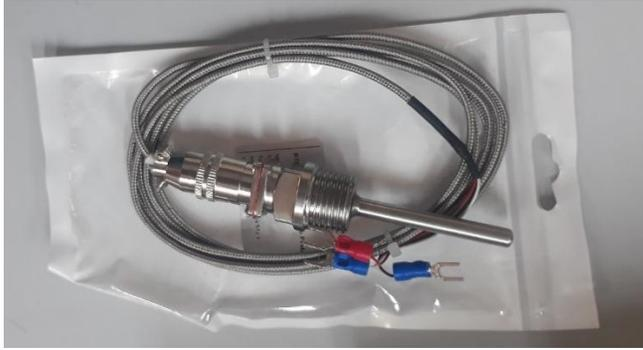
Figura D.3 Sensor de temperatura de parafina
