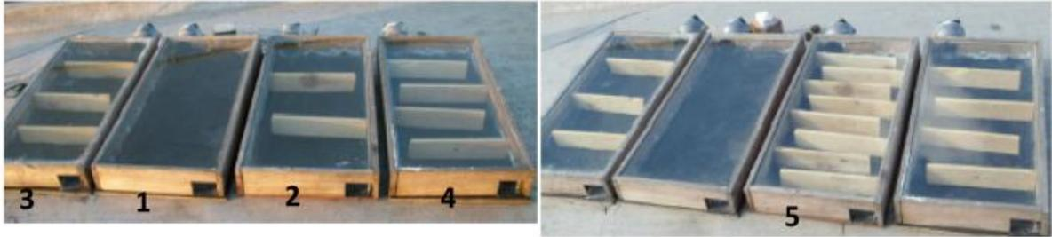
*Figura 3.8.* Colectores con deflectores transversales de madera.
