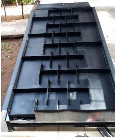
Figura C.4 Absorbedor – Contenedor vista superior
