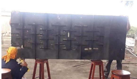
Figura E.6 Reparación contenedor – absorbedor
