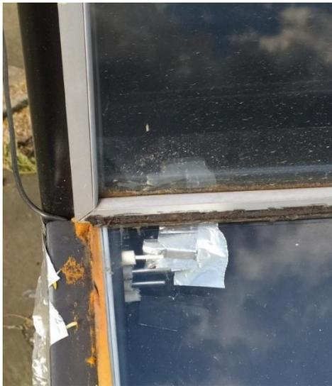
Figura D.15 Sensores de temperatura de aire y temperatura de superficie a la salida de aire del colector solar.
