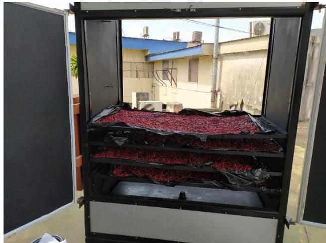
Figura F.6 Bandejas con frijoles en cámara de secado
