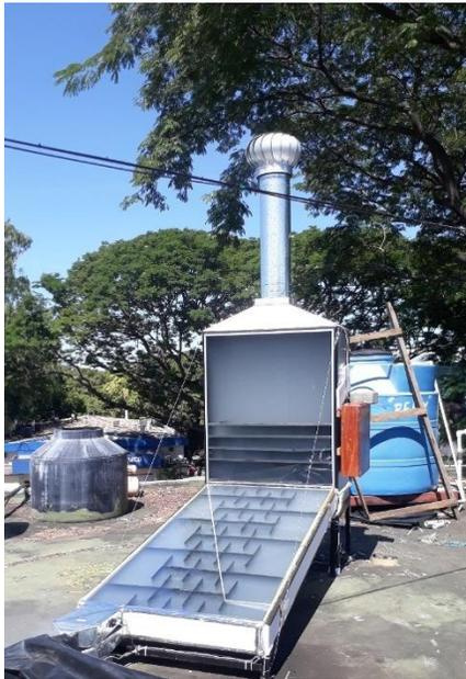
Figura E.11 Secador solar durante pruebas de fuga de aire
