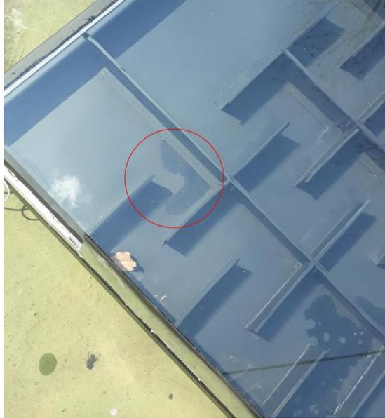
Figura E.1 Fuga de parafina en colector solar (primer deflector)
