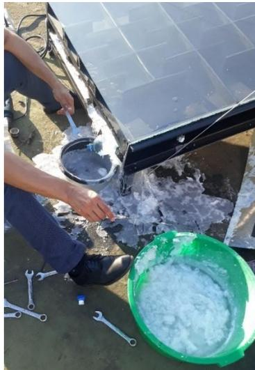
Figura E.5. Vaciado de parafina luego de identificación de fuga.
