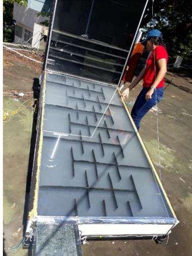
Figura E.10 Prueba de fugas de aire
