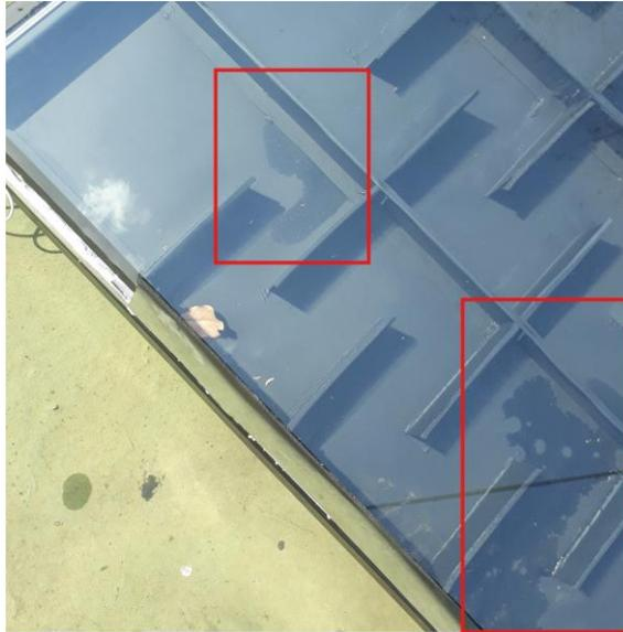
*Figura 5.6.* Fugas de parafina en colector solar
