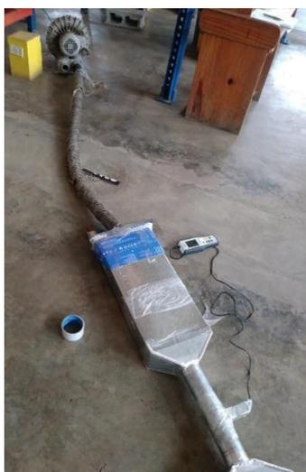
Figura D.8. Obtención de datos de velocidad y RPM del anemómetro utilizando un soplador tipo turbina.
