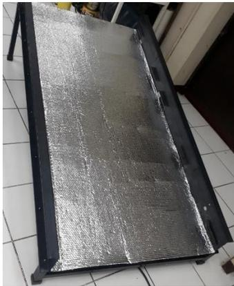
Figura C.5 Estructura de colector solar con lámina de aislante térmico aluminizado
