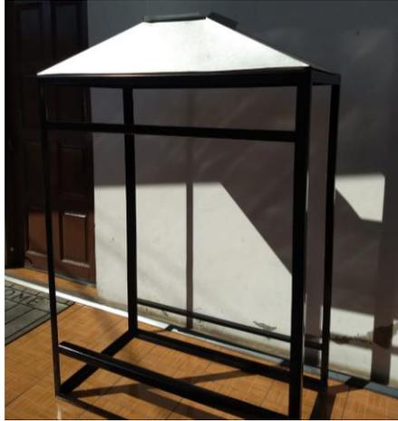
Figura C.7 Estructura de cámara de secado
