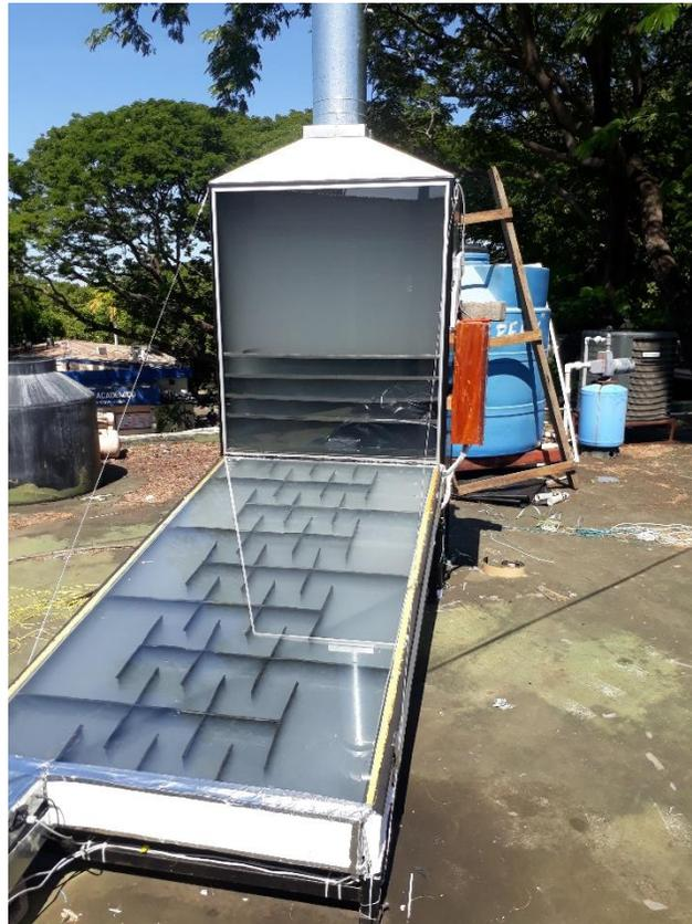
*Figura 5.5. Prueba de fugas de aire.*
