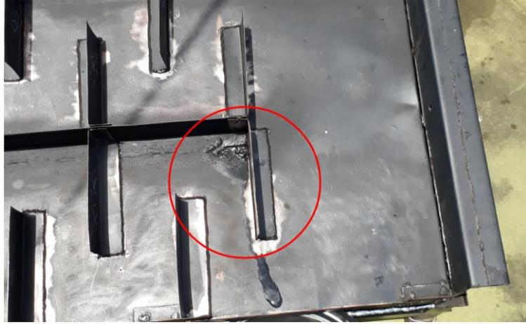
Figura E.4 Fuga de parafina en primera vuelta del colector-absorbedor
