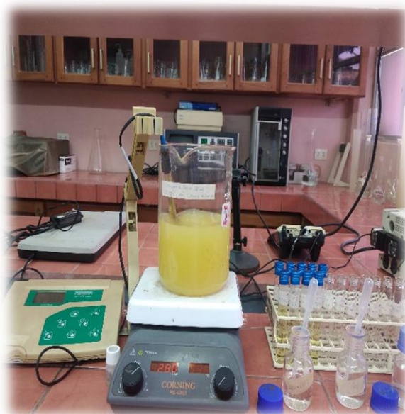
Figura A.6. Toma de muestras para el estudio de la Cinética de Adsorción.
