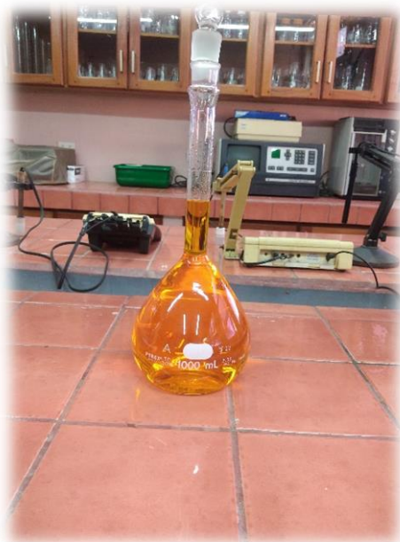
Figura A.3. Preparación de la solución madre de Cr VI
