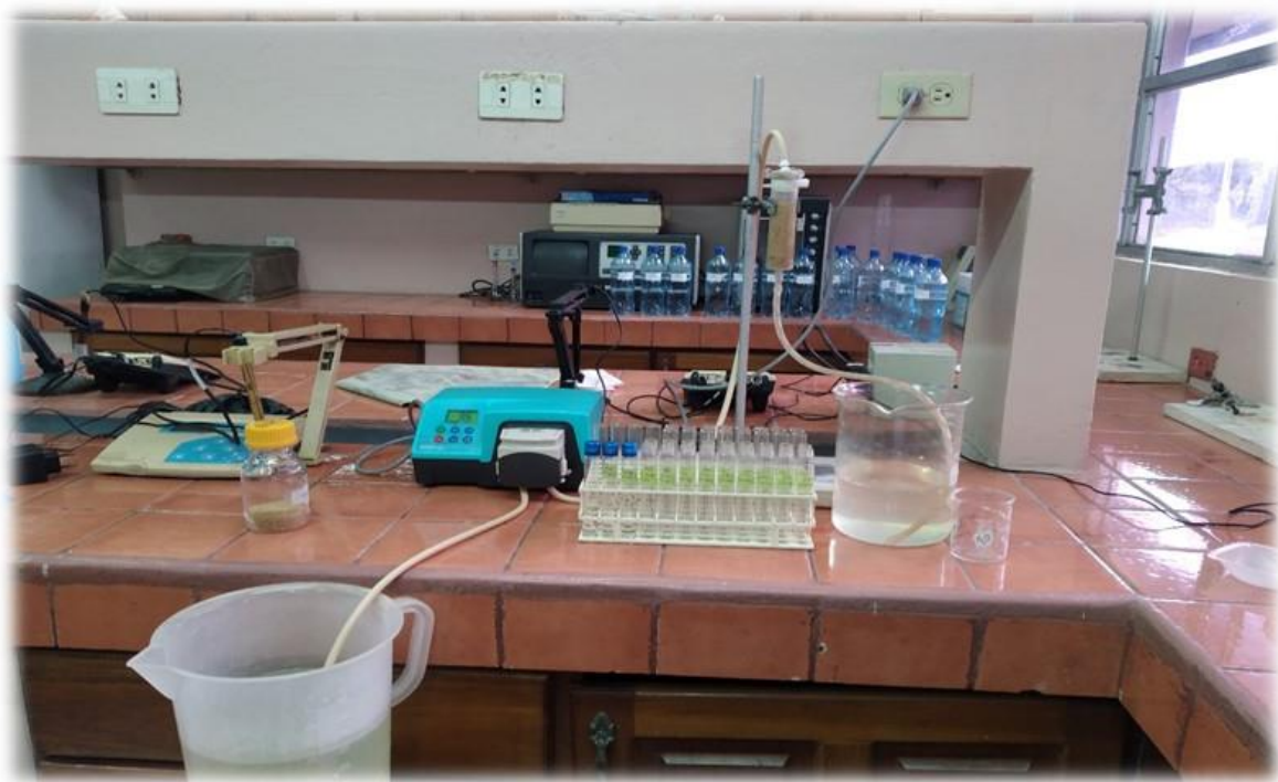
Figura A.8. Proceso de adsorción de cromo VI utilizando columnas empacadas con semilla de Moringa oleífera .
