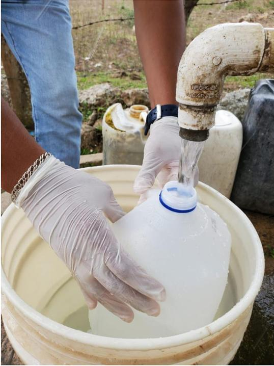
Ilustración 18: Muestras de agua para pruebas: bacteriológicas y físico-química
