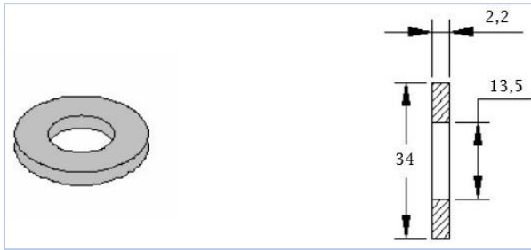
Figura 33: Dimensionado de la arandela.
