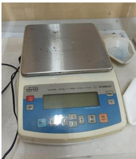
**Figura 2.1:** Balanza semi-analitica. (Elaboración propia)
