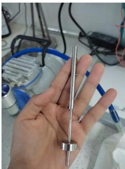
**Figura 2. 4:** Aguja L2 para Viscosímetro Brookfield Lamy Rheology modelo B-One plus LVT. (Elaboración propia)
