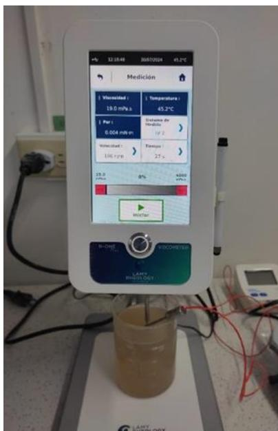
**Figura 2. 3:** Viscosímetro Brookfield Lamy Rheology modelo B-One plus LVT. (Elaboración propia)
