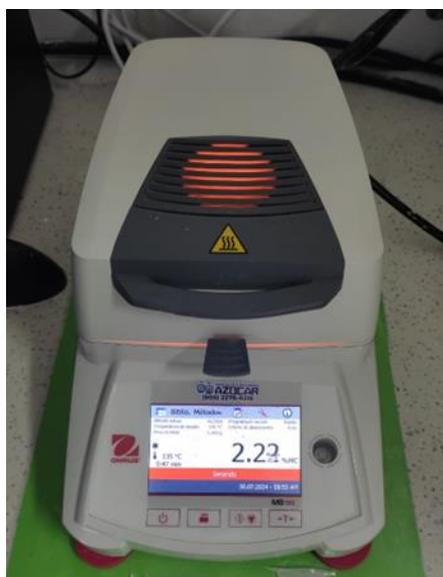
**Figura 2.2:** Detector de humedad. (Elaboración propia)
