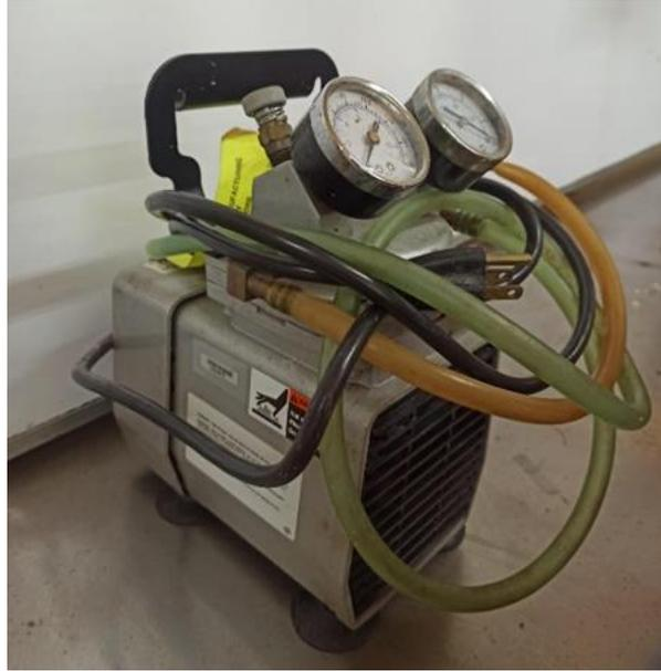
**Figura 2. 9:** Bomba de vacío. (Elaboración propia)
