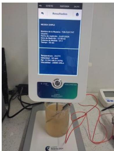
**Figura 6:** Medición de la viscosidad de muestra. (Elaboración propia)
