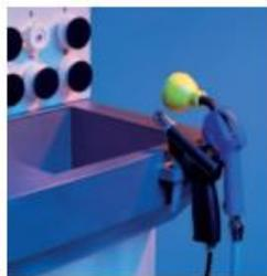
Compartimento para lavar lentes con chorro de agua y pistola de aire comprimido
