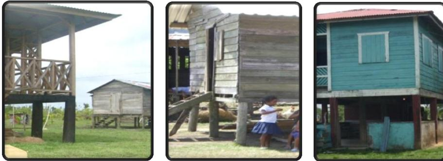
Fig. # 13, 14, 15: viviendas sobre pilotes de madera aserrada, madera rolliza o concreto.
