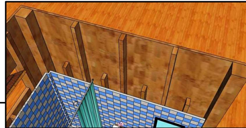
VISTA DE ESTRUCTURA DEL MURO BAJO EN BAÑO SE COLOCARAN POSTES DE MADERA EN MURO BAJO PARA EL RECUBRIMIENTO DE ESTE CON TABLACEMENTO MARCA DUROCK
