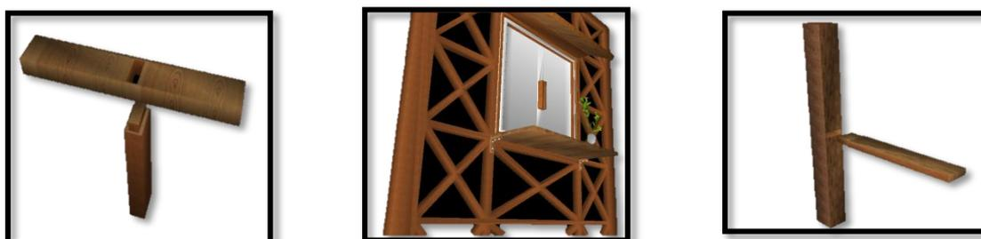
Fig N° 17: unión de elementos verticales y travesaños
